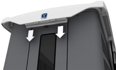
! Kontrollieren Sie dabei, ob sich das Zelttuch der Flexwand gut nach innen faltet und während des Schließvorgangs in allen Phasen den Hubmechanismus nicht behindert und auch nicht zwischen Wohnwagen und Hubdach eingeklemmt wird. Gehen Sie hierbei sehr sorgfältig vor, um Beschädigungen des Zelttuchs zu vermeiden. **ACHTUNG:** Beschädigungen am Zwischentuch durch unsachgemäßes Schließen des Hubdachs und der Nichteinhaltung des vorstehenden Verfahrens sind von der Garantie ausgeschlossen.
